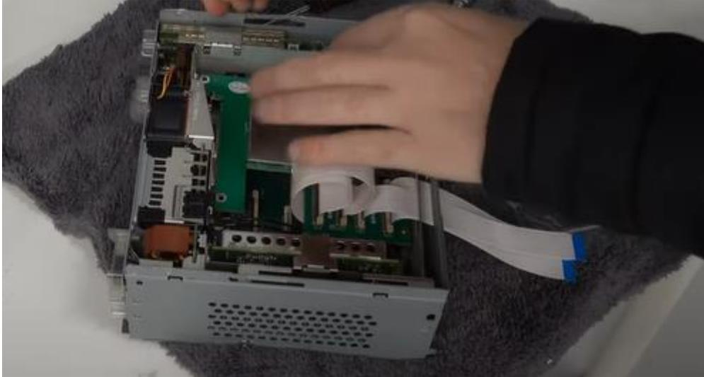
Schrauben Sie die neue (zusätzliche) Platine auf.
