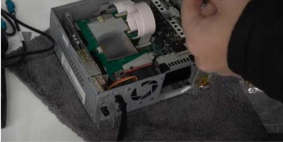
**Schritt 7. Montieren Sie das Radio wieder (Schrauben)**
