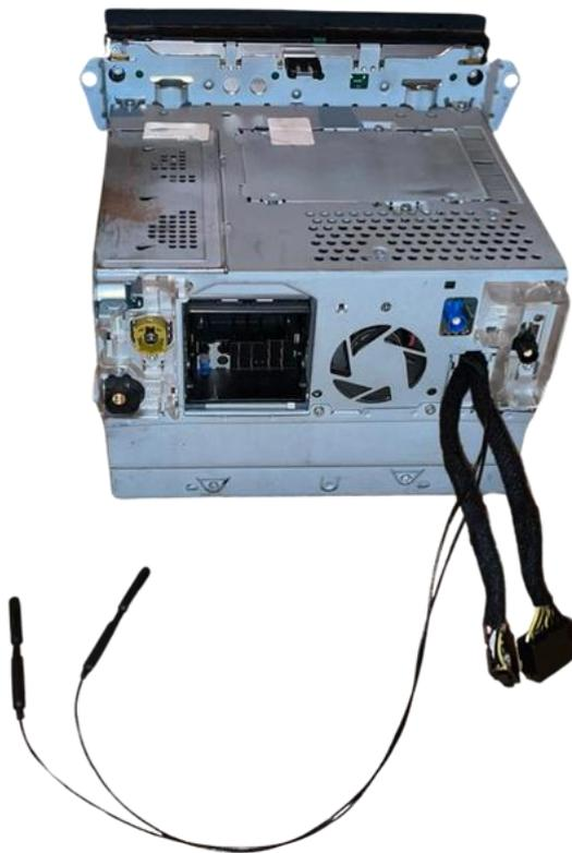
**Schritt 8. Verbinden Sie das Schnittstellenkabel mit dem Funkgerät (Stecker)**
