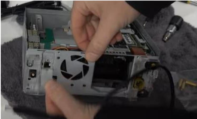
Entferne die Halterung neben der Entlüftung, um Platz für den Durchgang der beiden Kabel zu schaffen, die auf die Platine geklickt werden. Positionieren Sie auch die beiden Antennen.
